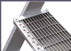
Gradino profondo 200mm. realizzato in grigliato d'acciaio zincato a caldo con superficie anti-scivolo, ideato anche per evitare depositi di neve su scale in ambienti esterni.
