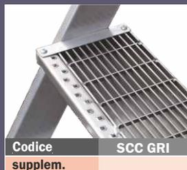
Gradino profondo 200 mm. realizzato in grigliato d'acciaio zincato a caldo con superficie anti-scivolo; ideato anche per evitare depositi di neve su scale in ambienti esterni
