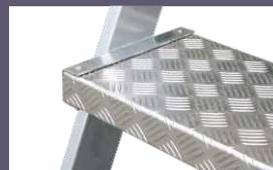
Gradino profondo 200 mm. realizzato in lamiera mandorlata che garantisce gradini molto robusti con spessore 3mm ed un anti-scivolo alto 2 mm. molto efficace
