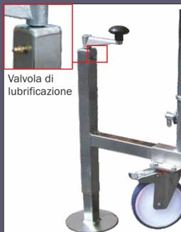
**Stabilizzatori/livellatori a vite** in acciaio zincato con piattello per base rigida sono utili per compensare pendenze o dislivelli fino a 27 cm. con la massima precisione dotati di valvola di lubrificazione per garantire una lunga durata nel tempo
