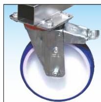
**Ruote Ø 150 mm. Made in Italy anti-schiacciamento con freno anteriore** Fissata su piastra con nucleo in poliuretano anti-schiacciamento e fascia di appoggio anti-traccia adatta per l'uso su pavimenti pregiati
