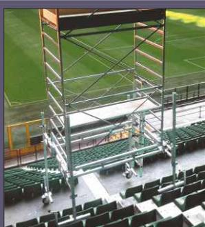
**Base GIGANTE con grande capacità di regolazione.** Realizzata in acciaio zincato tralicciata, regolabile in larghezza e provvista di n° 4 grandi livellatori regolabili in altezza capaci di compensare dislivelli fino a mt. 1,5. e di n° 4 stabilizzatori a vite. Ideata per un utilizzo su gradinate stadi o su poltrone cinema.
