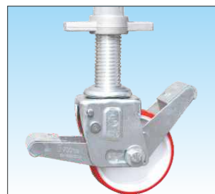
Ruote pivotanti Ø 150 mm. in poliuretano con livellamento integrato su ruota fino a 30 cm
