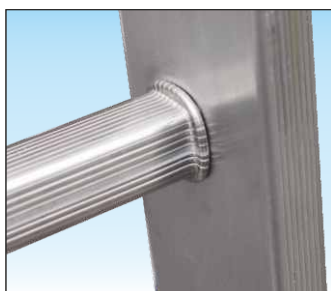
Piolo quadro mm. 30 x 30 anti-scivolo molto robusto con doppia bordatura Unione tra piolo e montante con doppia bordatura, interna ed esterna, per la massima solidità contro urti accidentali e per una lunga durata nel tempo
