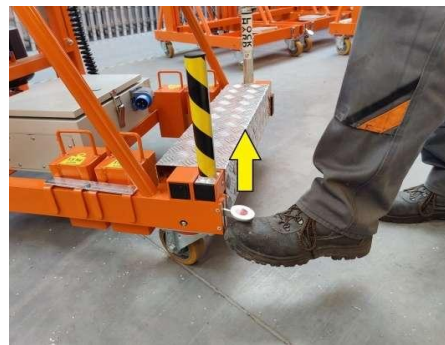
Foto 6. Sblocco delle ruote Sollevare il pedale sblocca le ruote
