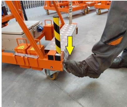
Foto 5. Bloccaggio delle ruote Premere sul pedale lo blocca
