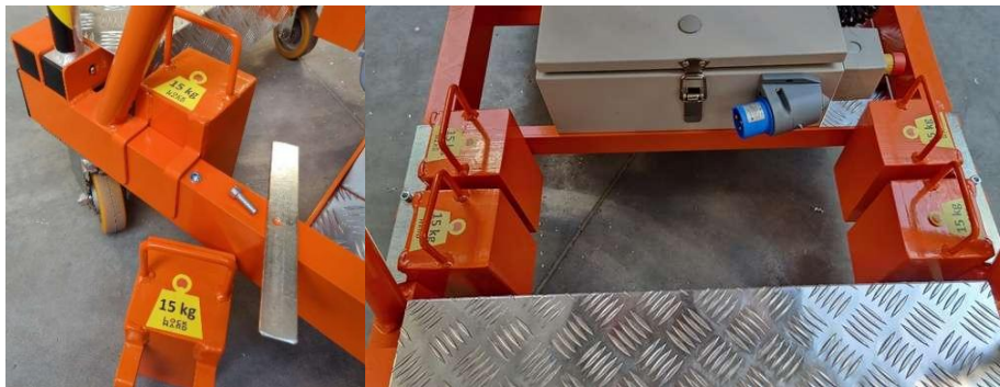
Foto 4. Montaggio delle zavorre
